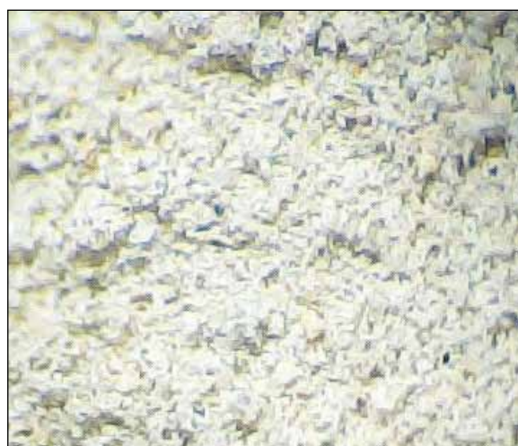
Рис. 2. Структура бентонитовой глины Северо-Джамансайского месторождения в виде порошка. ×600
