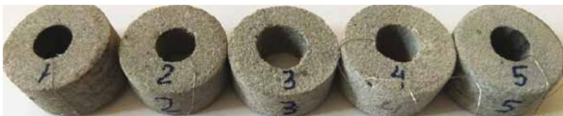
Рис. 5. Образцы для исследования пористости по длине мембраны
