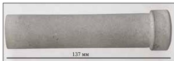
Рис. 3. Синтезированная мембрана (общий вид)
