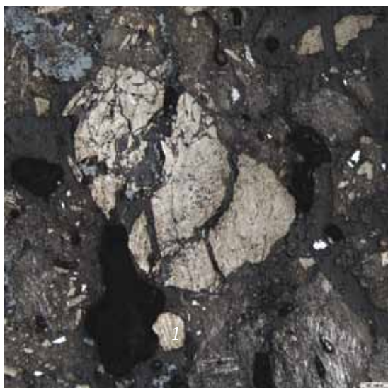
Рис. 5. Микроструктура углеродистого гарнисажа разновидности 3 (образец G10.1 ): светло-серое — первичный графит (из футеровки); темно-серое — аморфный углерод и полуграфит; ярко-белое — металл ( \text{Fe} + \text{Fe}_3\text{C} ); черное — стеклофаза (шлак). \times 190 . Свет отраженный
