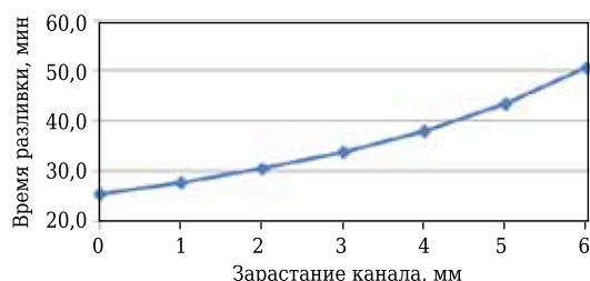
Рис. 3. Влияние зарастания канала стакана-дозатора из огнеупорного бетона № 3 на время одной разливки
