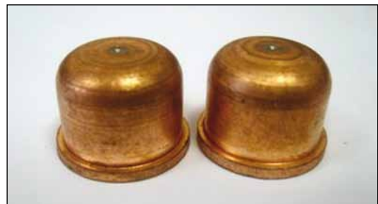
Рис. 2. Электроды ЭП18Цр до лабораторных испытаний на мобильной многофункциональной плазменной установке
