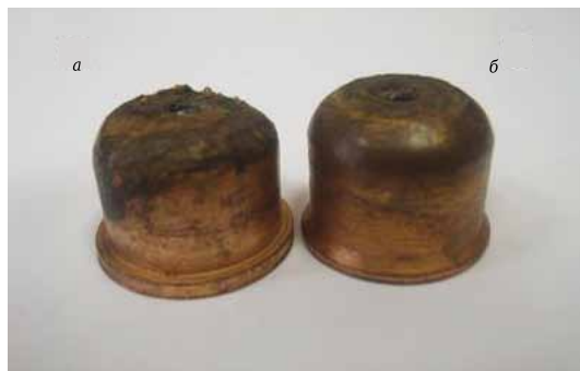
Рис. 3. Электроды ЭП18Цр после лабораторных испытаний на мобильной многофункциональной плазменной установке: а — плазмообразующий газ (сжатый воздух); б — плазмообразующий газ (сжатый воздух) + горячие углеводороды от ДВС
