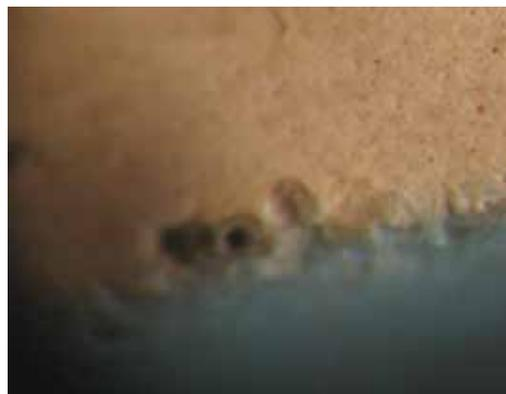
**Рис. 3.** Коррозионные язвы на ребрах образца с оксидно-керамическим покрытием.  $\times 10$
