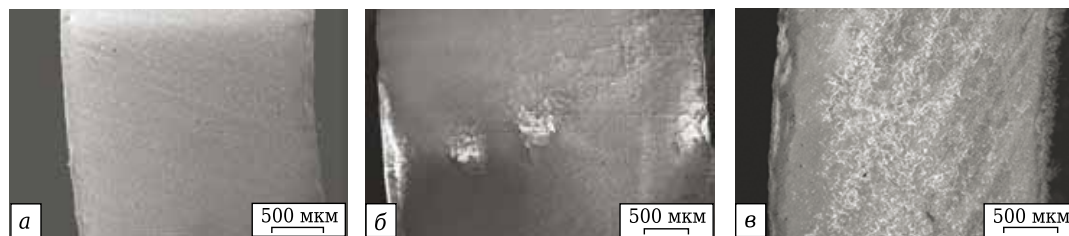
Рис. 2. Срез диафрагмы после изготовления (а) и после испытаний в течение 8000 (б) и 40000 ч (в)
