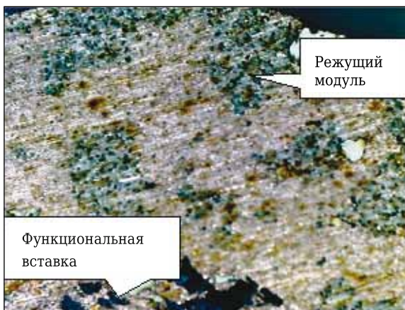
Рис. 12. Рабочая поверхность сегмента для среднего шлифования неабразивных материалов (×8)
