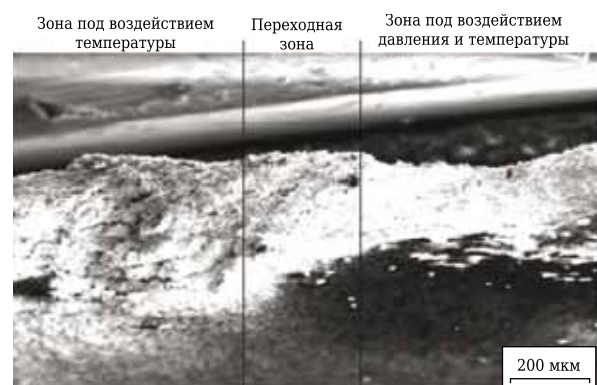
Рис. 9. Изображение поперечного среза покрытия в переходной области
