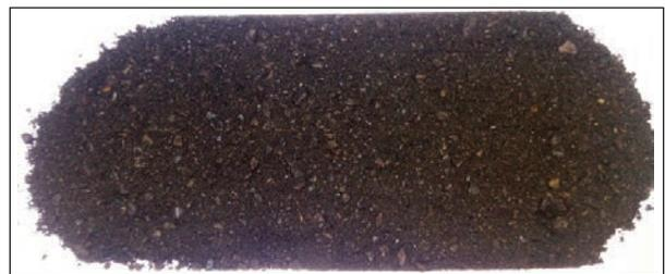
**Рис. 3.** Магнезиальная ремонтная масса марки GIR-RB-X (экспериментальный образец)
