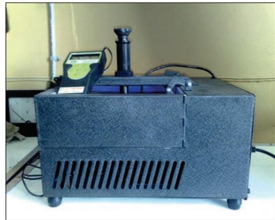
Рис. 2. Измеритель теплопроводности ИТП-МГ 4 «250»
