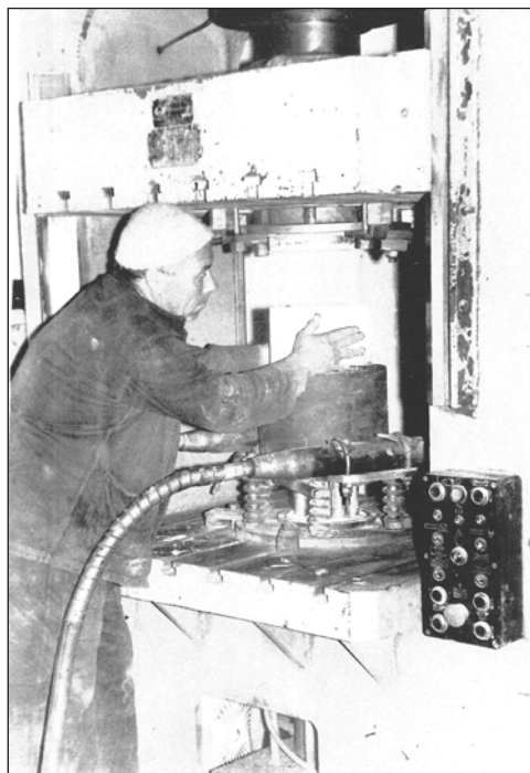
Рис. 1. Пресс-форма квазиизостатического прессования со встроенными вибраторами
