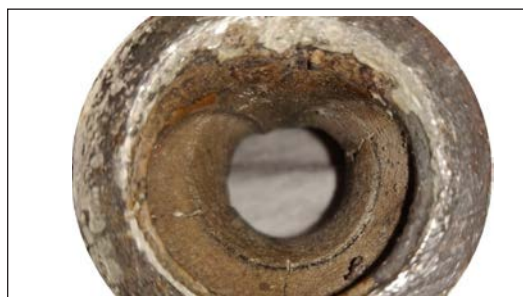
Рис. 5. Циркониевая вставка с неравномерным размытием калибровочного канала
