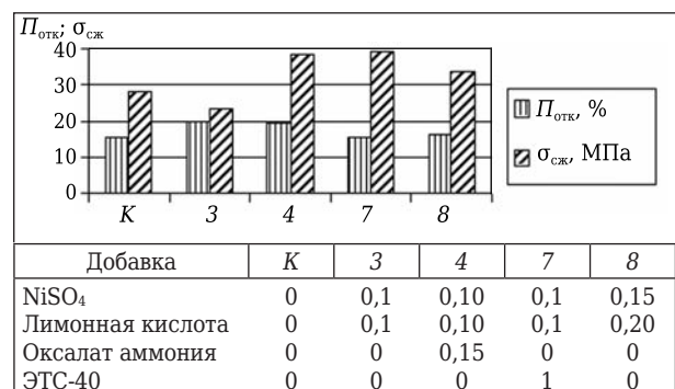
Рис. 3. Результаты физико-механических испытаний образцов составов 3, 4, 7 и 8 с модифицирующими добавками ФФС ( \text{NiSO}_4 , ЭТС-40, лимонная кислота и оксалат аммония)
