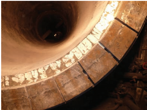
Рис. 3. Общий вид подпорных плит горячего обреза и футеровки вращающейся прокалочной печи
