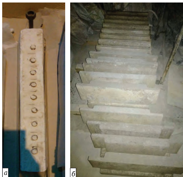
Рис. 2. Вибролитые изделия компании GIR-ENGINEERING для промежуточного ковша: а — продувочная балка для рафинирования металла; б — перегородки для организации движения потоков
