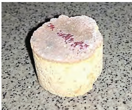
Рис. 4. Опытный образец после нескольких погружений в расплав для определения термостойкости
