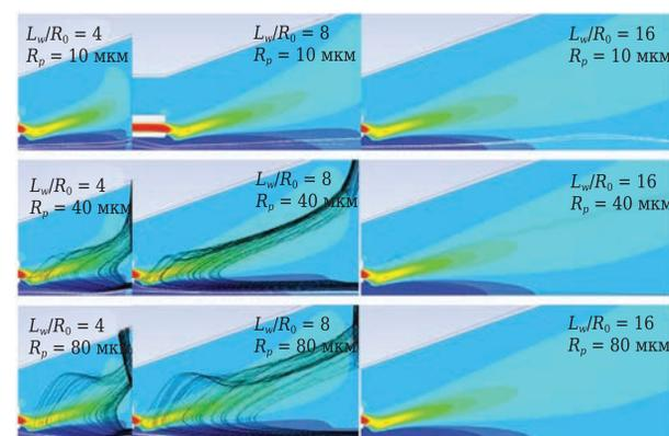
**Рис. 6.** Сравнение контуров осевой скорости и траектории частиц для различных расстояний до стенки и диаметров частиц:  $Q_S/Q_0 = 0,5, S_0 = 0,556$
