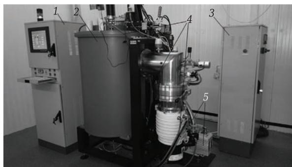
**Рис. 2.** Установка для термообработки НИКА-М60: 1 — стойка управления; 2 — вакуумная камера; 3 — регулятор мощности; 4 — система водяного охлаждения; 5 — вакуумная система
