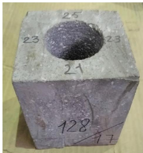
**Рис. 3.** Корундохромоксидный тигель до испытаний
