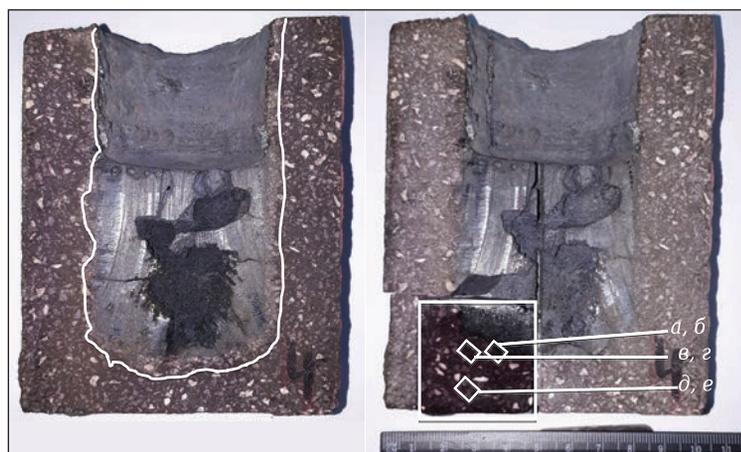
**Рис. 6.** Срезы тигля в эксперименте № 4 с видимой зональной пропиткой (слева) и выбор участков для петрографического исследования (справа)
