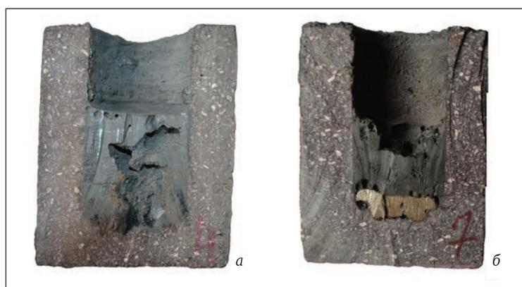
**Рис. 5.** Разрезы тиглей после расплавления (окалина) (а) и восстановления (окалина + коксик) (б)
