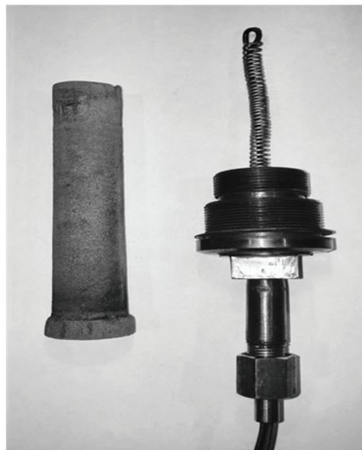
**Рис. 5.** Металлокерамическая мембрана (слева) и водородселективная Pd-Ru-мембрана (справа)
