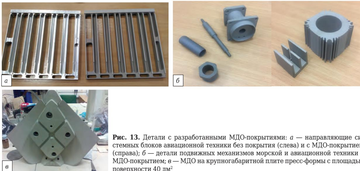
**Рис. 13.** Детали с разработанными МДО-покрытиями: а — направляющие системных блоков авиационной техники без покрытия (слева) и с МДО-покрытием (справа); б — детали подвижных механизмов морской и авиационной техники с МДО-покрытием; в — МДО на крупногабаритной плите пресс-формы с площадью поверхности 40 дм<sup>2</sup>
