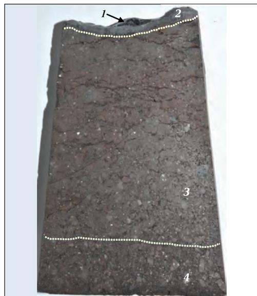
**Рис. 5.** Изделие А после службы. На спиле прослеживаются: 1 — шлаковая корочка; 2 — рабочая зона; 3 — зона пропитки силикатами с наличием сетки трещин; 4 — холодная зона
