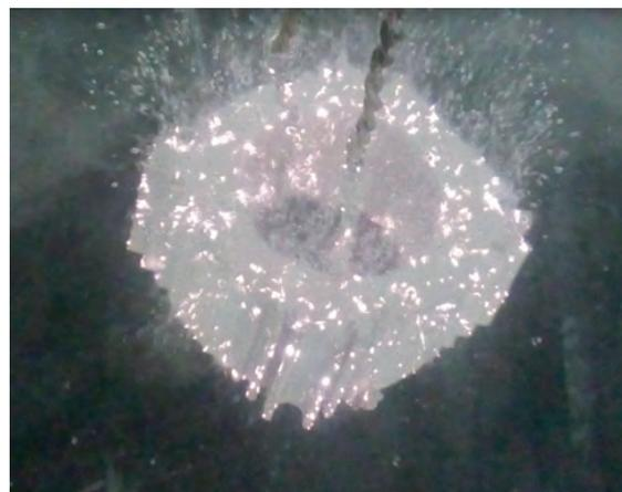
Рис. 5. Микроплазменные разряды на поверхности алюминиевой детали (МДО)
