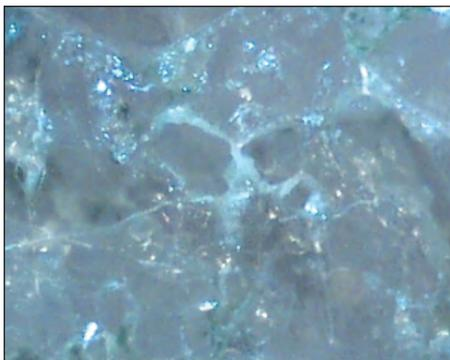
**Рис. 3.** Фотография шлифа поверхности побочного продукта автоклавного производства кристаллов кварца.  $\times 60$ . Свет отраженный
