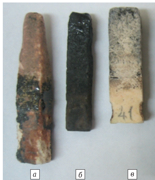
Рис. 3. Эрозия образцов огнеупоров Бк-33 (а), AZCS-30B (б) и AZS-41 (в), испытанных в динамических условиях в составе 2
