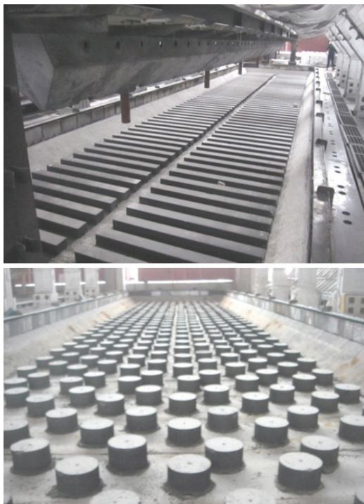
Рис. 1. Рельефная подина по технологии Novel structure of cathode (NSC) компании Chalco
