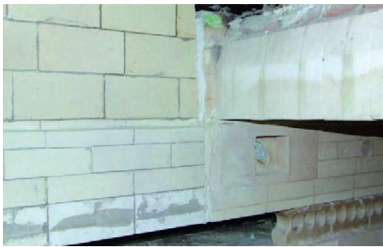
Рис. 3. Волокнисто-армированные изделия с керамической алюмосиликатной матрицей в футеровке свода щелевой роликовой печи обжига керамической плитки
