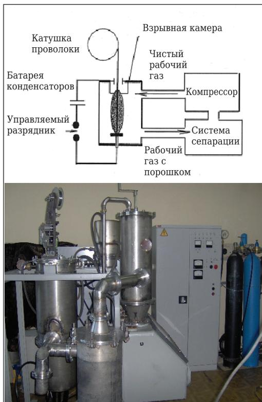
Рис. 2. Схема и внешний вид установки ЭВП
