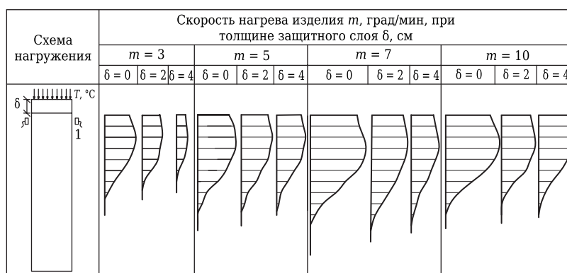
Рис. 2. Нарушение сплошности структуры хромомagneзитовых огнеупоров в зависимости от скорости их нагрева и толщины защитного слоя
