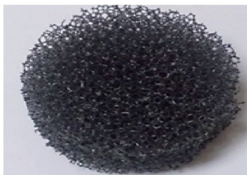
Рис. 1. Внешний вид высушенного образца с диаметром ячейки 3–5 мм
