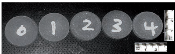
Рис. 2. SiC/AlN-композиты после спекания при 2080 °C в течение 2 ч
