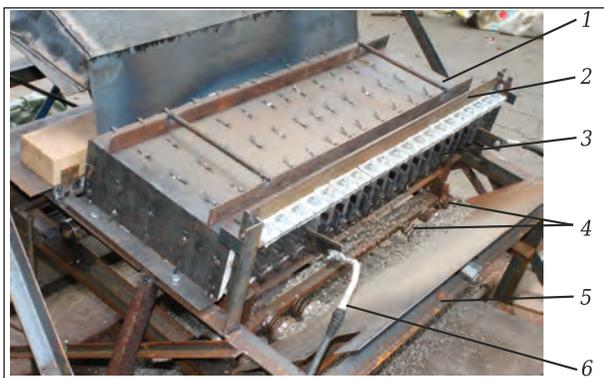
Рис. 1. Физическая модель: 1 — термокрышка; 2 — панель; 3 — крепления; 4 — пружины; 5 — рама; 6 — кабель
