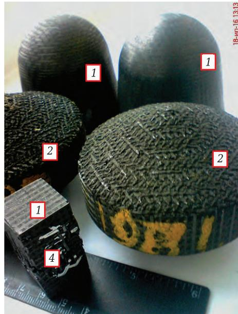
Рис. 6. Детали из УУКМ: 1 — исходные детали после механической обработки поверхности; 2 — поверхности после эксплуатации; 3 — механически разрушенный образец после определения предела прочности при сжатии
