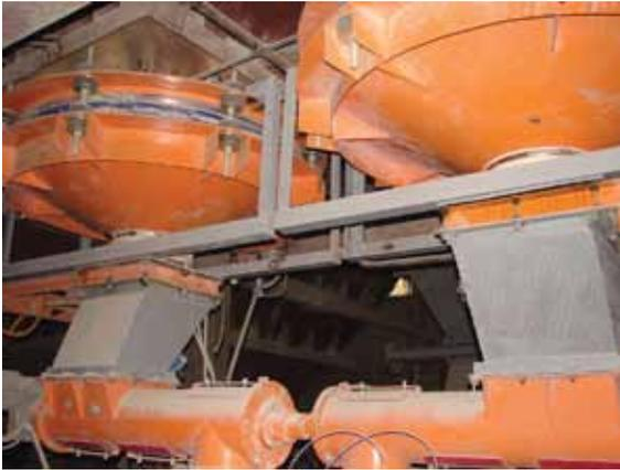
**Рис. 6.** Автоматические весовые дозаторы
