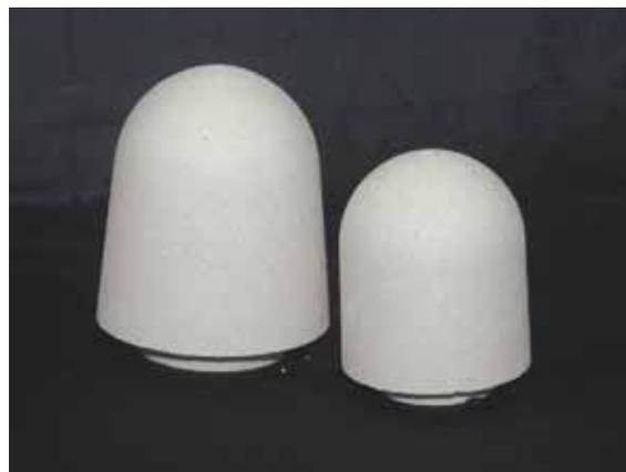
Рис. 2. Муллитокорундовые пробки
