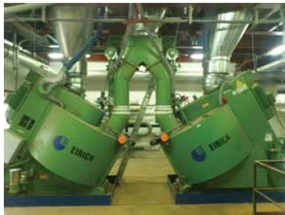
**Рис. 1.** Смесители-грануляторы «Eirich» в технологической схеме производства пропантов
