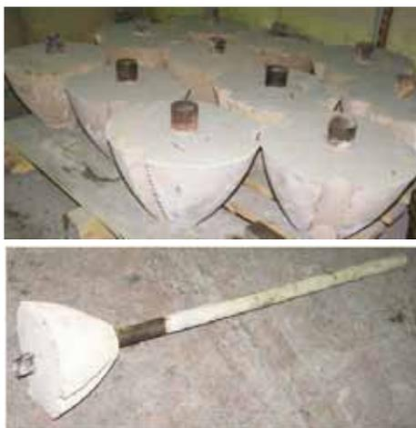
**Рис. 5.** Конус отсечки шлака
