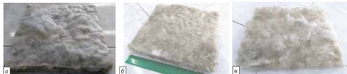
Рис. 2. Образцы материала, полученные с использованием поливинилацетатной эмульсии (а), раствора сульфозфира целлюлозы (б) и полиэфирного волокна (в)
