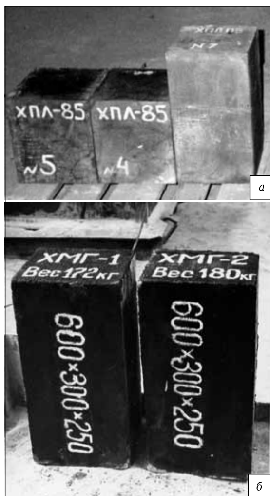
Рис. 3. Промышленные стеновые брусья ХПЛ-85 размерами 450(300)×250×250 мм (а) и ХМГ (б)
