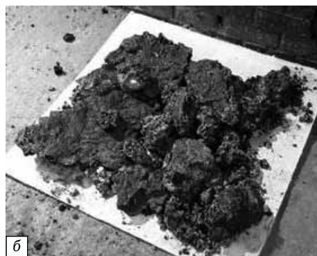
Рис. 2. Отбор пробы шлака (а) и куски стабилизированного шлака (б)
