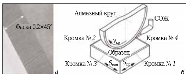
Рис. 1. Фаска на кромке образца (а) и схема шлифования (б)
