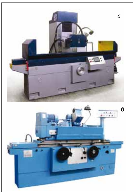
Рис. 2. Плоско- (а) и круглошлифовальный станок (б)
