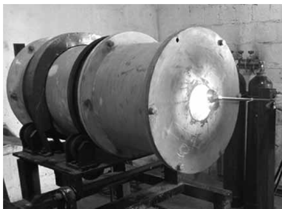
Рис. 1. Лабораторная печь для определения шлакоустойчивости
