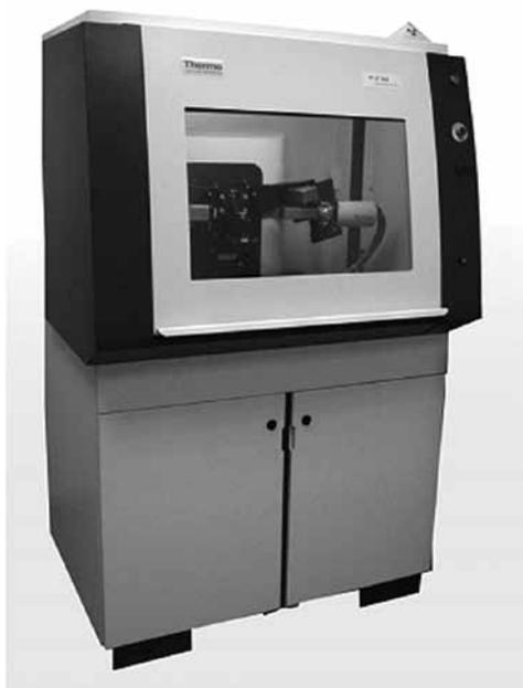
**Рис. 10.** Рентгеновский дифрактометр «X'tra» фирмы ARL
