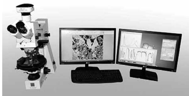
**Рис. 4.** Оптический микроскоп «Axioplan» фирмы «Carl Zeiss»
