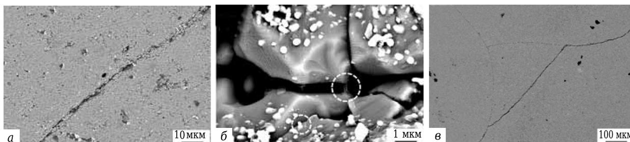
**Рис. 7.** Микроструктура образцов, спеченных при 1400 °С, после воздействия термоудара. Содержание добавки  $\text{Al}_2\text{O}_3 + 4\text{SiO}_2$  в образцах, мас. %: а — 0; б — 15; в — 30
