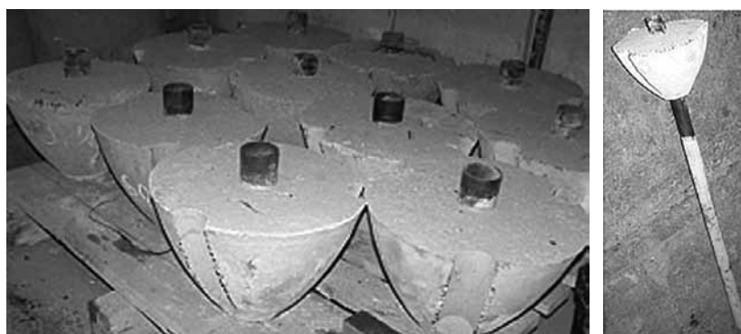
Рис. 3. Огнеупорные изделия для отсечки шлака (конус)
