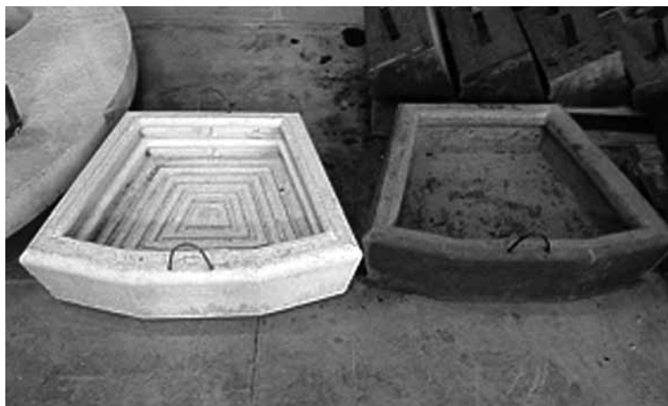
Рис. 5. Металлоприемники «рейнстрим™»: слева — высокоглиноземистый; справа — периклазовый
