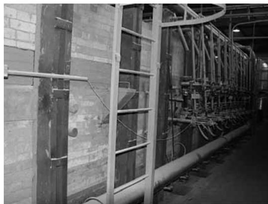
Рис. 2. Высокотемпературная туннельная печь ЗАО «ПКФ «НК»
