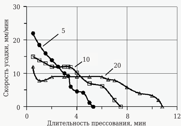
Рис. 7. Кинетика усадки при консолидации шихты из термопластичного шликера; цифры на кривых — число слоев бумаги в теплоизолирующих прокладках
