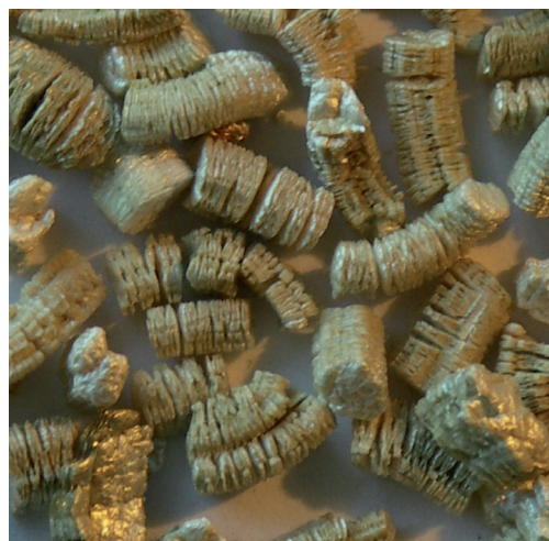
Рис. 4. Полностью вспученный вермикулит (фрагмент фотографии)
