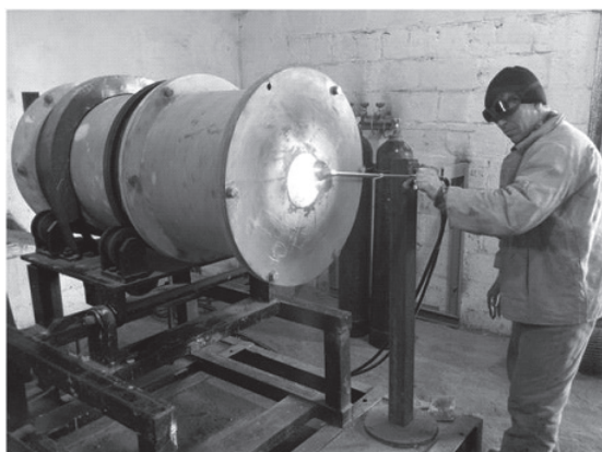
Рис. 1. Барабанная печь в режиме разогрева. Регулировка интенсивности работы газовой горелки
