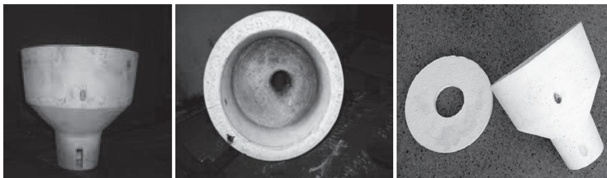
Воронка дозирующего узла плавильно-литьевого устройства
