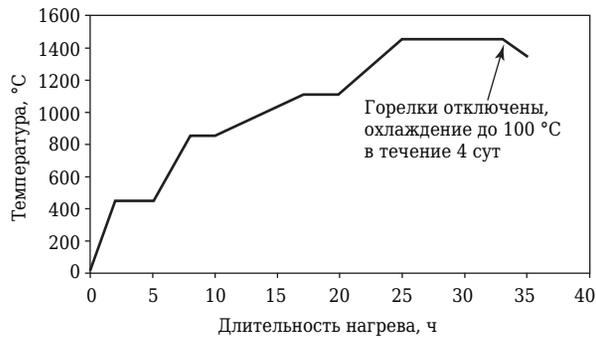
**Рис. 2.** Режим азотирования при обжиге крупногабаритных SNBSC-блоков
