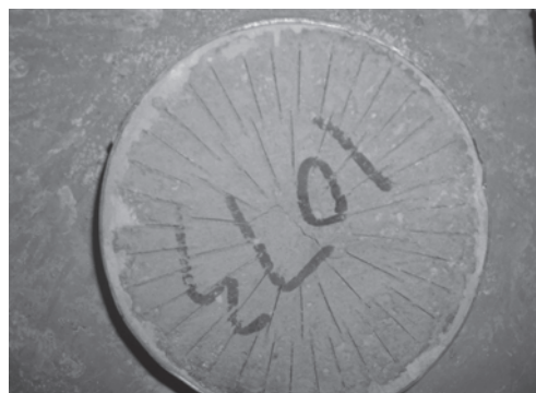
Рис. 6. Продувочные пробки с радиальным расположением продувочных каналов
