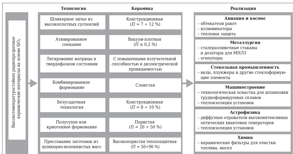
Рис. 1. Керамические материалы на основе SiO 2 , технология их получения и области применения (П — пористость)
