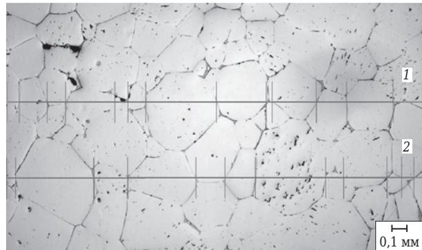
**Рис. 1.** Участок плавного периклаза. Оценка размеров отдельных кристаллов, попавших в поле объектива микроскопа, методом пересекающих линий (хорд).  $\times 25$ . Свет отраженный. Выбранные для измерений линии сечения 1 и 2
