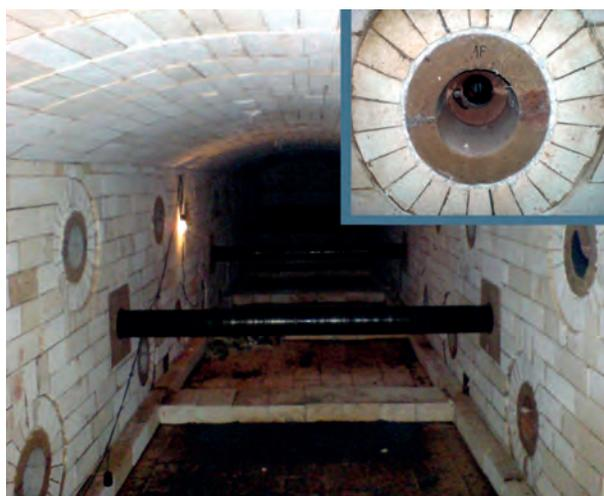
Рис. 5. НЛМК, печь непрерывного горячего цинкования АНГЦ-3 после двух лет работы, 2011 г. (проект компании «Теплохиммонтаж»)
