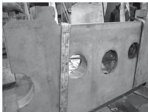
Рис. 3. Элемент крышки для промежуточного ковша, футерованной по бетонной технологии
