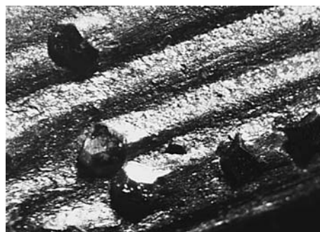
Рис. 1. Микрофотография рельефа режущей поверхности при сверлении бакорового огнеупора
