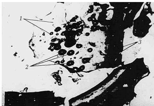
Рис. 4. Микрофотография стекла, полученного из каназита при 750 °С: 1 — области стекла с n_d = 1,541 ; 2 — газовые пузыри; 3 — неосветленное стекло
