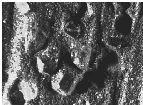
Рис. 4. Микрофотография рельефа алмазного кластера в рабочем слое инструмента при обработке высокопрочного бетона
