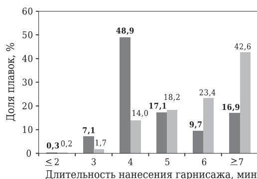
Рис. 3. Распределение плавков опытной кампании по продолжительности нанесения шлакового гарнисажа на футеровку с присадкой МГФ в процессе раздува шлака азотом (■) в сравнении с плавками без МГФ (□)
