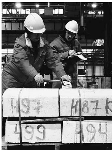
Рис. 2. Измерение ЧСК подовых блоков прибором «Звук-203М»
