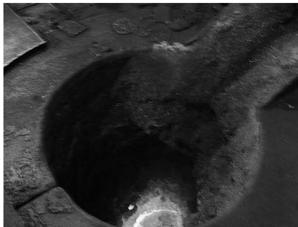
Рис. 1. Образование настыва в 25-т индукционной печи
