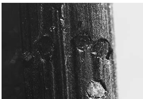
Рис. 3. Микрофотография рабочей поверхности режущего слоя сегментного отрезного круга для бакорового огнеупора. Конечная стадия работы кластера. Зерна, составляющие кластер, выработаны практически полностью
