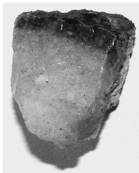
Рис. 3. Фрагмент футеровки 25-т индукционной печи: 1 — рабочая зона; 2 — переходная зона; 3 — наименее измененная зона
