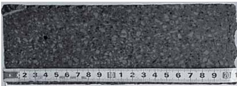
Рис. 1. Фотография периклазогерцинитового изделия после службы
