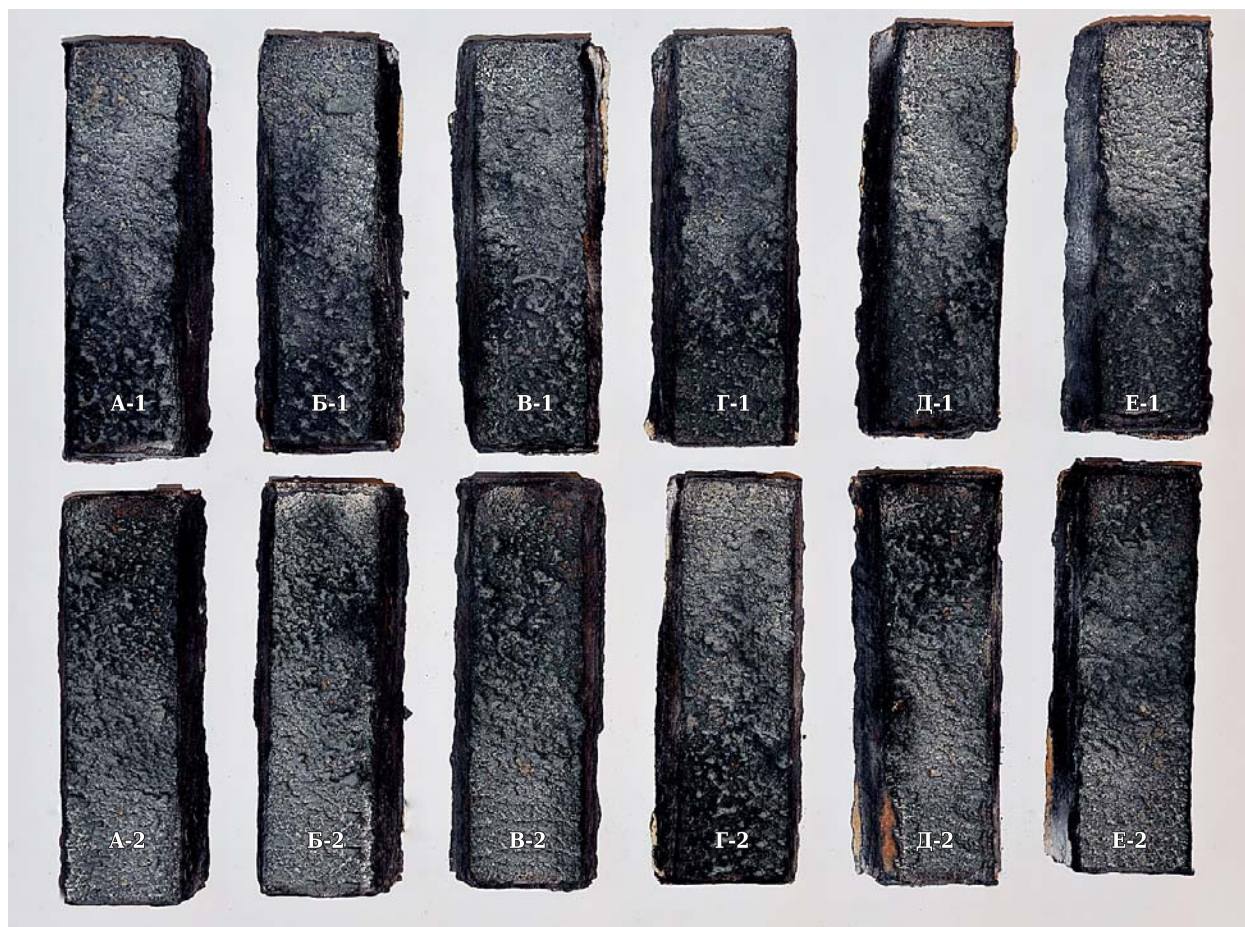
Рис. 2. Образцы изделий после испытания и разборки тигля
