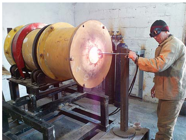
Рис. 1. Печь в режиме разогрева, регулировка интенсивности работы газовой горелки
