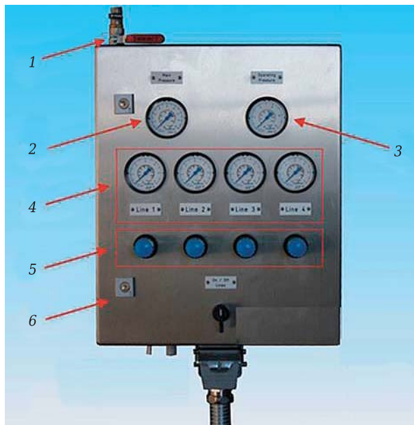
Рис. 4. Панель управления: 1 — шаровый кран 1/2 дюйма и главный кран подвода давления; 2 — манометр и значение питающего давления (1–16 бар); 3 — манометр и значение рабочего давления (1–10 бар); 4 — манометр (деления от 1 до 6) и показатель давления соответствующих линий (1–6 бар); 5 — регулятор давления (деления от 1 до 6) и регуляторы для настройки давления подачи необходимого количества гранулята по линии; 6 — замок двери
