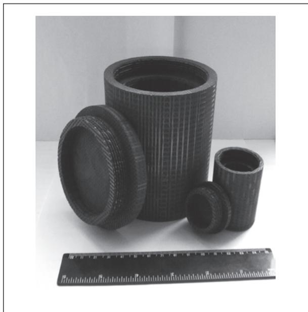
Рис. 1. Теплозащитные корпуса из УУКМ
