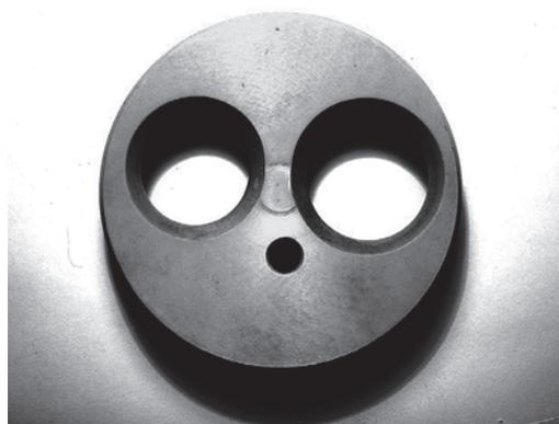
Рис. 3. Керамическая головка цилиндра из титаната алюминия
