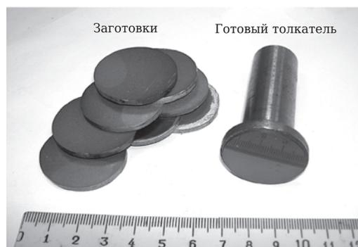
Рис. 5. Керамические заготовки и толкатель клапана с нитридкремниевым рабочим телом
