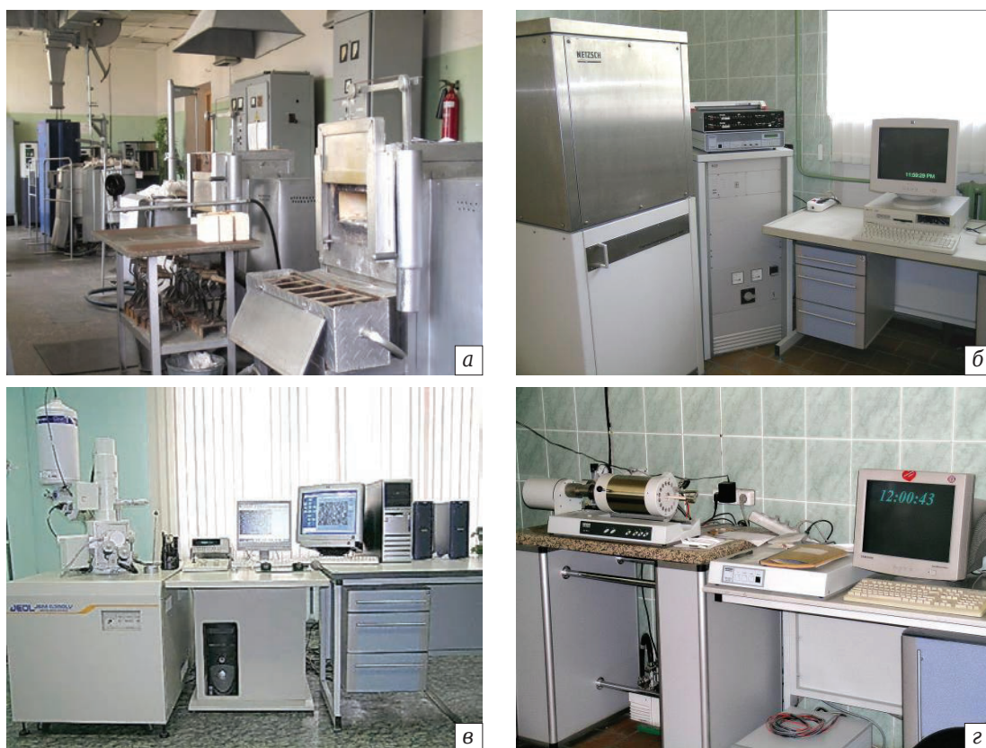
Рис. 1. Элементы научно-технической базы ЦСТП: а — лаборатория термических испытаний; б — установка для определения теплопроводности; в — система электронной микроскопии «Jeol 6380 LV»; г — установка для определения ТКЛР
