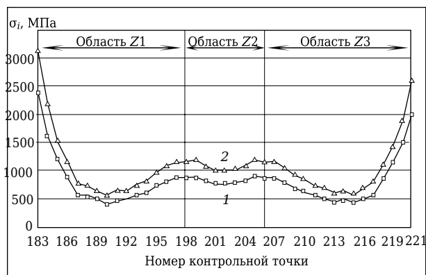
Рис. 5. Влияние тепловой нагрузки на интенсивность напряжений \sigma_i в КТ поверхностного слоя матрицы, примыкающего к межзеренной фазе, в керамике системы ZrO_2-MgO-ZrO_2-Cu . Номера комплексов тепловых потоков указаны на кривых
