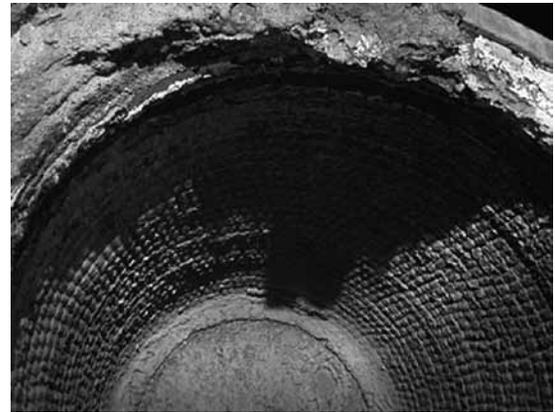
Рис. 3. Экспериментальный ковш после службы
