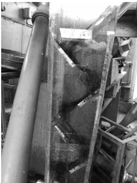
Рис. 2. Процесс отмывки никелевого шлака (расход воды 38 м³/мин)
