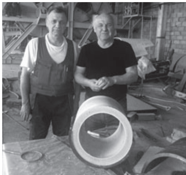
Рис. 8. Центробежноформованное трубчатое изделие диаметром 300 мм из химически стойкого кремнеземистого керамобетона
