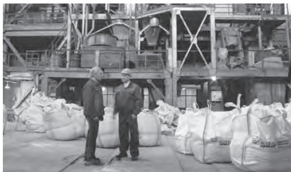
Рис. 6. Производственный участок по получению керамобетонных масс
