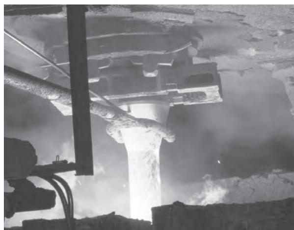
Рис. 5. Кварцевая защитная труба в эксплуатации на ММК
