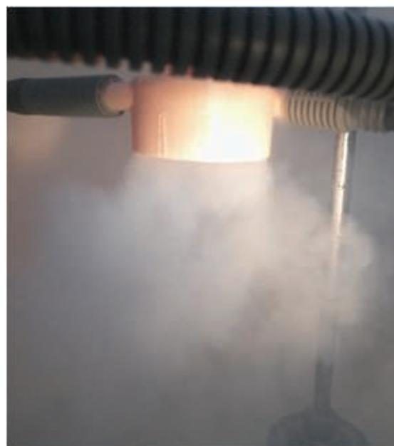
**Рис. 5.** Визуализация воздушного течения вблизи вихревого отсоса
