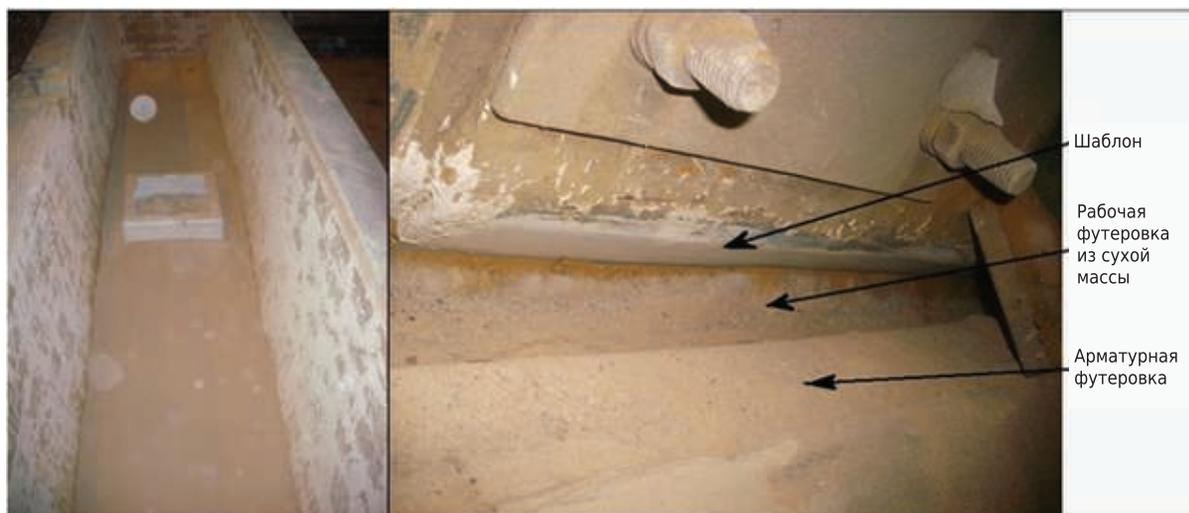
**Рис. 8.** Футеровка промежуточного ковша МНЛЗ сухой массой (слева — футеровка дна; справа — стены)
