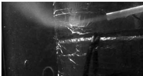
Рис. 4. Движение дыма при совместной работе вентиляторов
