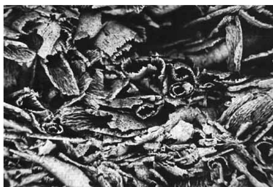
Рис. 4. Структура материала, полученного нагревом стружки, нарезанной на токарном станке из отливки, изготовленной из шликера на основе кремния, в свободно насыпанном состоянии
