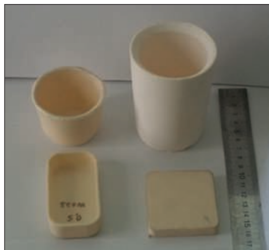
Рис. 6. Корундовые тигли и лодочки, полученные методом литья в гипсовую форму
