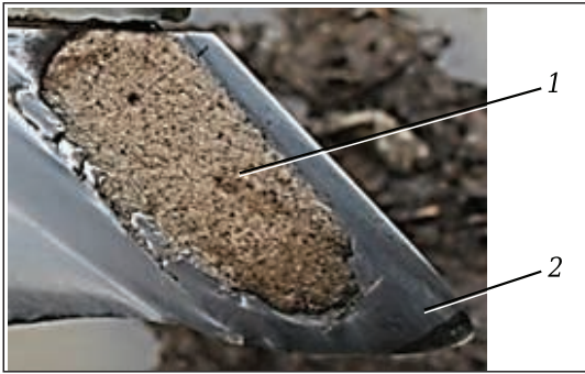
Рис. 1. Состояние поверхностей композита (1) и металла детали (2, сталь 65Г) после эксплуатации (долотообразная часть плужного лемеха после обработки 10 га супесчаных почв)
