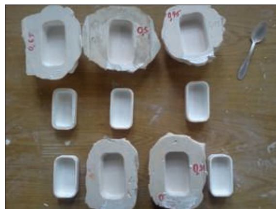
Рис. 1. Гипсовые формы и отлитые заготовки лодочек
