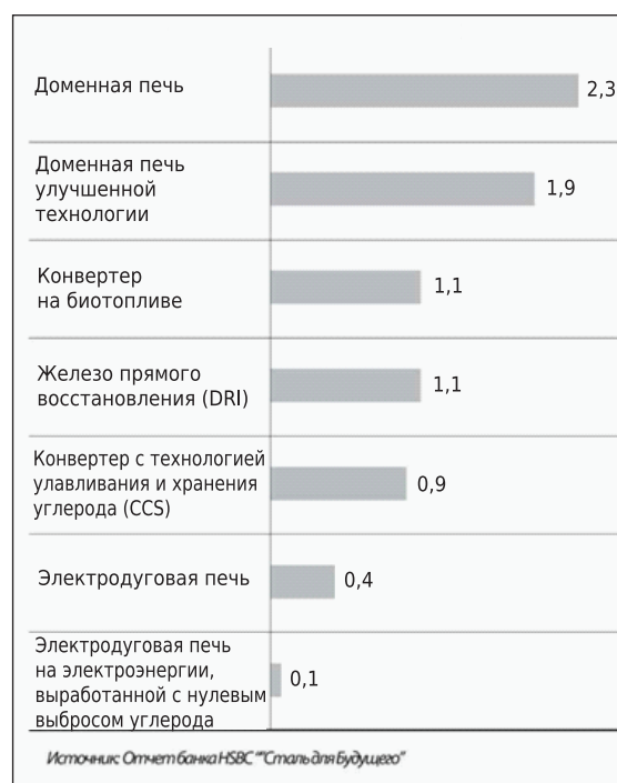
Рис. 4. Выбросы CO 2 на отдельных передлах металлургии (указаны в т CO 2 / т стали)
