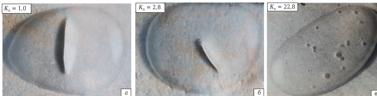
Рис. 2. Капли электровакуумного стекла C52-1 после испытаний на пузыреобразование при контакте с огнеупором Jargal M (а), МК-1 (б) и БКЧ-33 (в)
