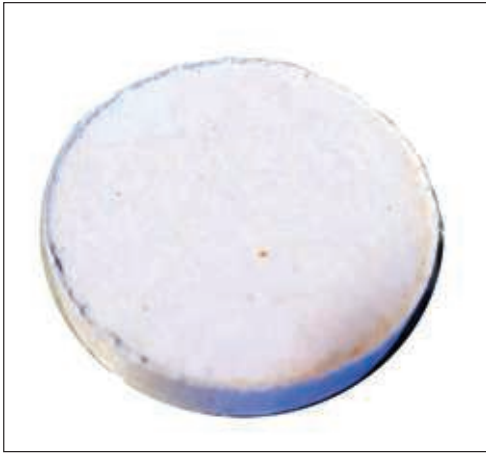
Рис. 1. Мембрана на основе ПСК, полученная прессованием порошка ПСК с инертной связкой
