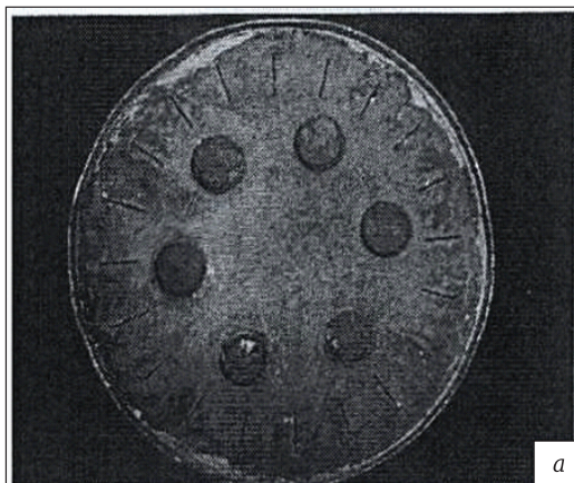
Рис. 2. Продувочная фурма с комбинированной структурой газохода (а, б)
