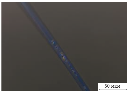
Рис. 4. Растянутое жидкое включение, близкое по реологии к основному раствору
