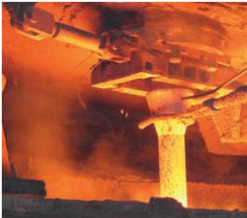
**Рис. 9.** Кварцевая защитная труба в эксплуатации на ММК
