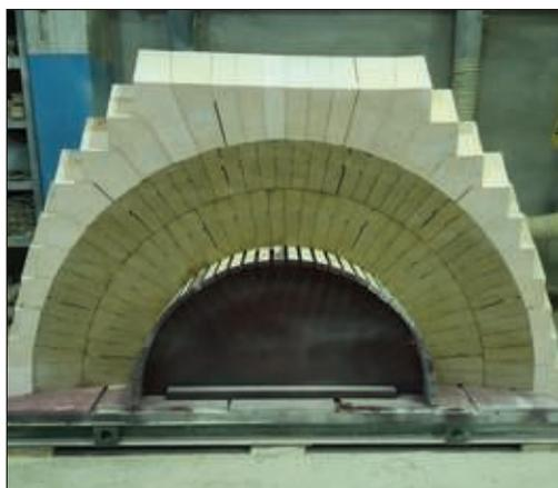
Рис. 19. Штыцер горячего дутья воздухонагревателя доменной печи, собранный из комплекта кварцевых керамобетонных блоков
