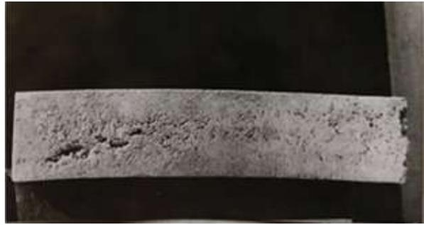
Рис. 2. Сырец, полученный при недостаточной продолжительности виброуплотнения
